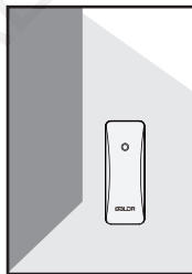
Powieszenie nadajnika na ścianie przy użyciu gwoźdźcia
